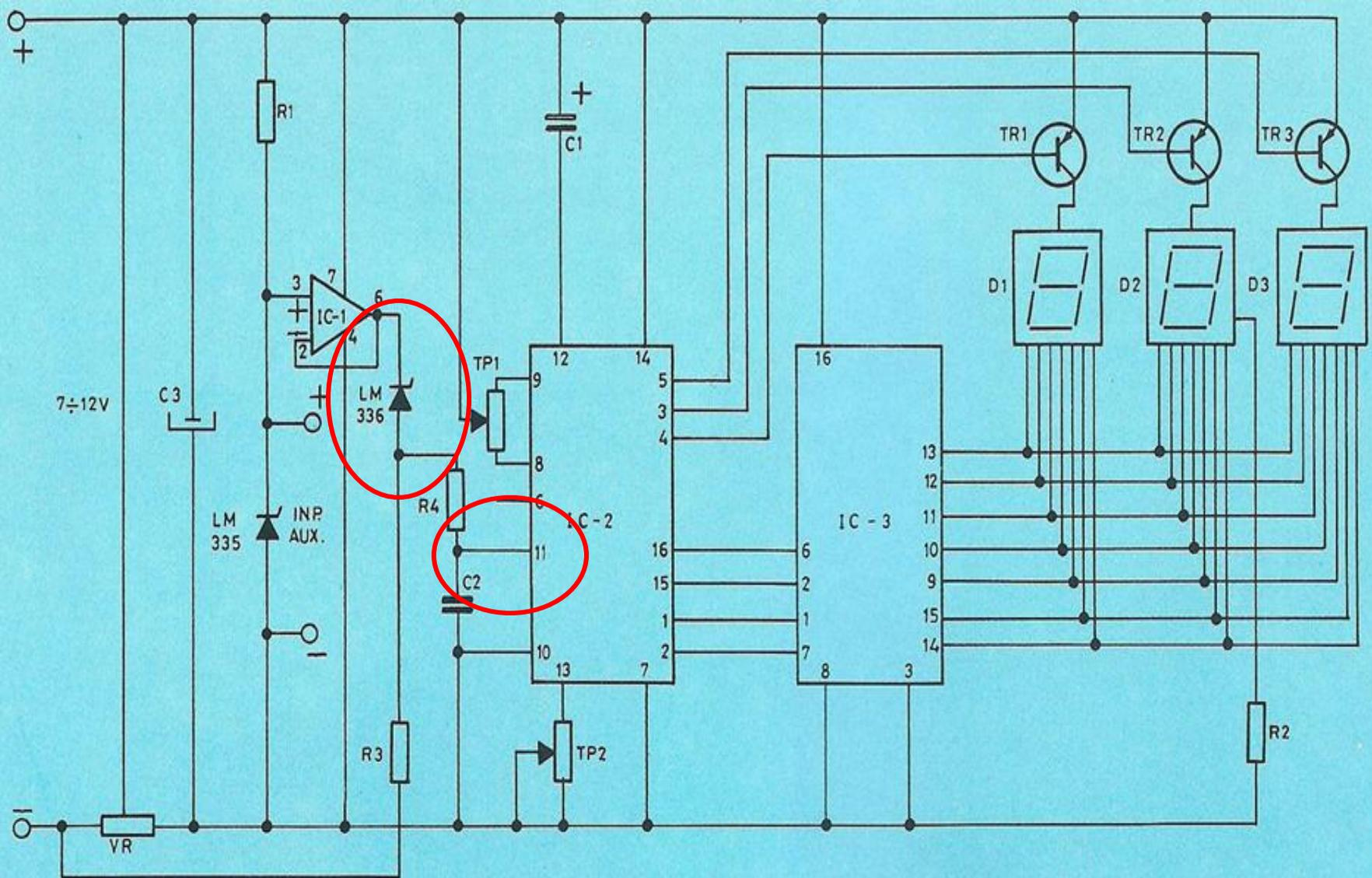
A la salida de este paso se encuentra el circuito LM336 de referencia de tensión, con objeto de adaptar la continua al nivel necesario para alcanzar el circuito IC2 en el pin 11, que es un **convertidor analógico-digital** que transforma las variaciones que recibe en su entrada en señales digitales en sus salidas.
