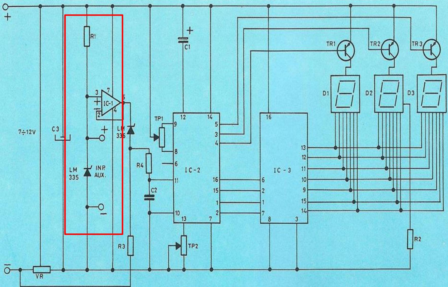
**La resistencia R1 alimenta el sensor de temperatura LM335 cuyas variaciones de tensión son recogidas por el amplificador integrado IC1 por la entrada 3.**
