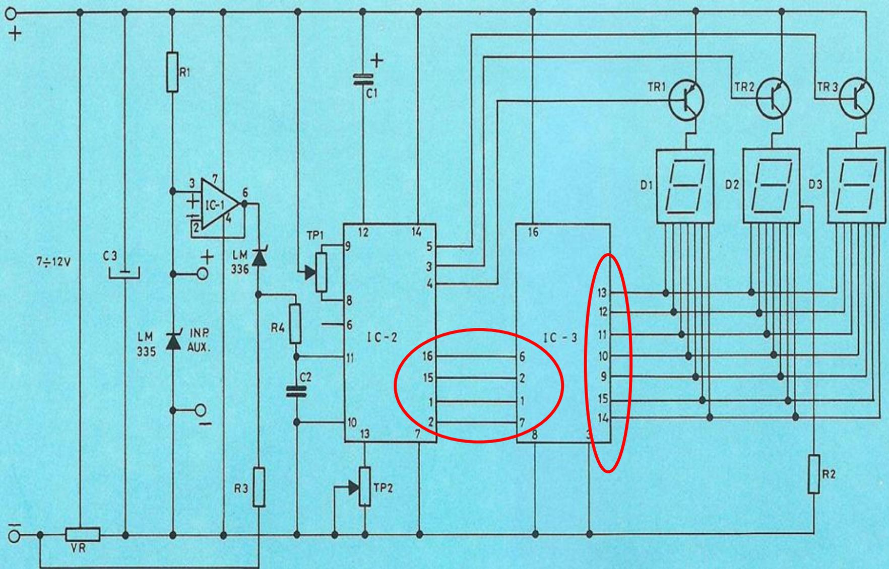
**El circuito integrado IC3 transforma las cuatro señales que recibe de los pines de salida 1, 2, 15 y 16 de IC2 en las siete señales necesarias para producir el encendido de los segmentos luminosos que componen el dígito de cada display.**
