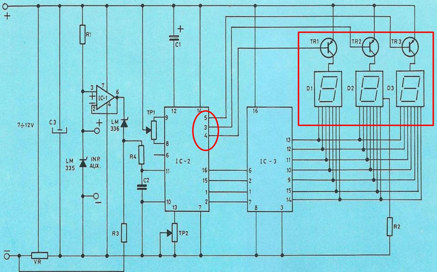
Las indicaciones con 3, 4 y 5 de IC2 se emplean para dar tensión a los transistores TR1, TR2 y TR3, que polarizan los ánodos de los displays.
